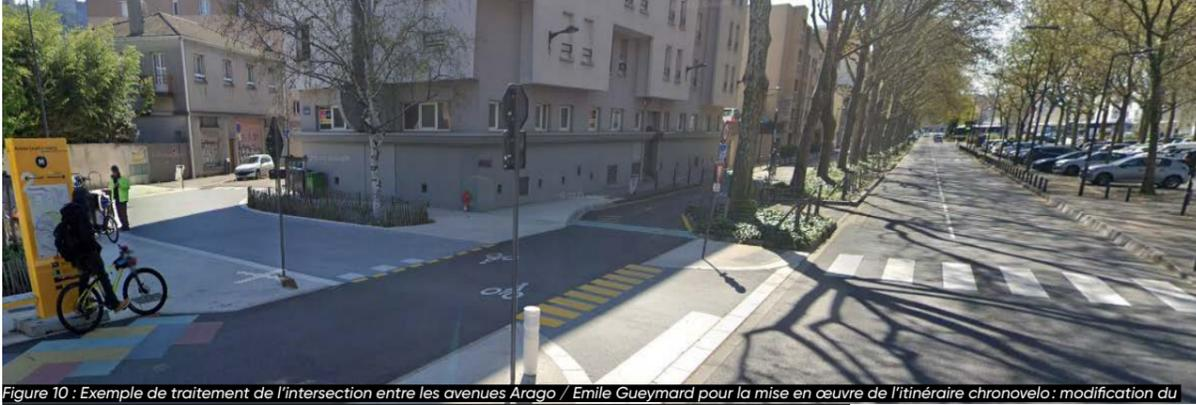
Figure 10 : Exemple de traitement de l'intersection entre les avenues Arago / Emile Gueymard pour la mise en œuvre de l'itinéraire chronovélo : modification du régime de priorité, mise en place d'un trottoir traversant et matérialisation visuelle de la traversée © Google Earth
